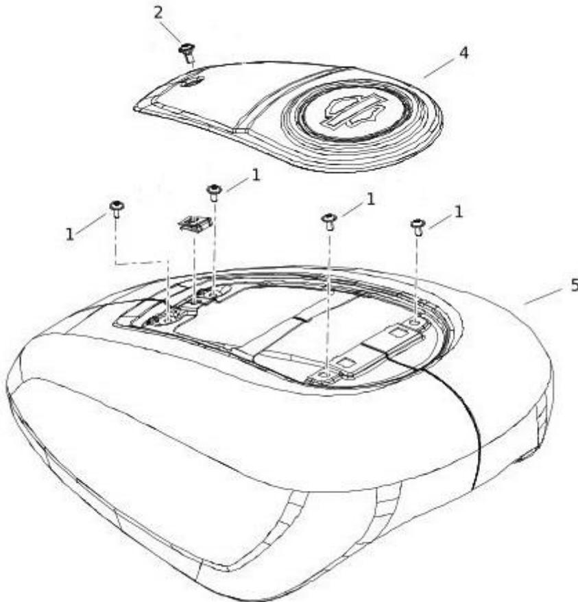
Lösen Sie die vier Schrauben (1) und entfernen Sie komplette Luftfilterkasten-Abdeckung (5).
