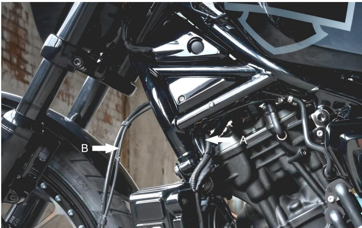
In diesem Zuge kann auch das Kabel des ABS-Sensors (B) verlegt werden. Dieses hat einen Steckverbinder unter der oberen linken Rahmenabdeckung.
