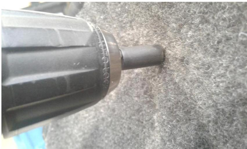
Installieren Sie die beiliegenden Blindnieten 4\*12.
