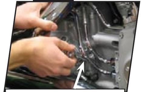
**SLIP THE COVER BEHIND THE OIL LINE AND OVER THE TRANSMISSION SIDE DOOR**
